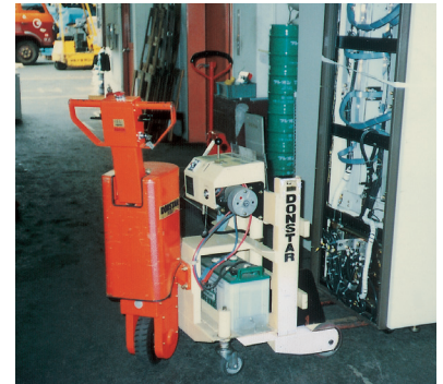
コンピューター組立枠の移動、けん引 ドンスタータグJ・B2
