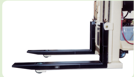
エルダ50-15S・35-20・50-20・30S・50S ドンスター50-15S・35-20・50-20のフォークは最大に広げた時は、前脚上かぶせ式になります。
