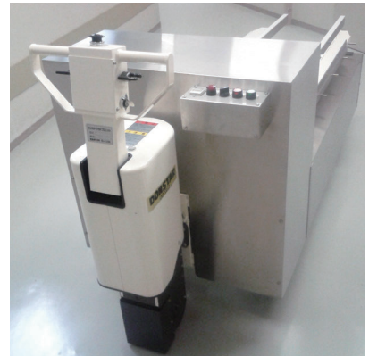
・板台車に取り付け (静音型ドライブユニット仕様)
