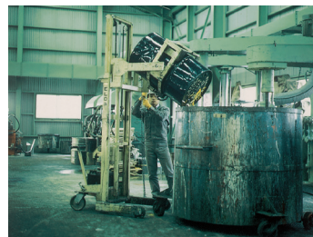
ドラム缶内容物の高所投入 カロードEDM4(高揚用)
